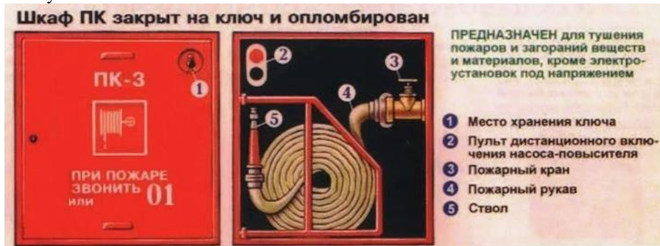
Рисунок 7. Внутренний пожарный кран
